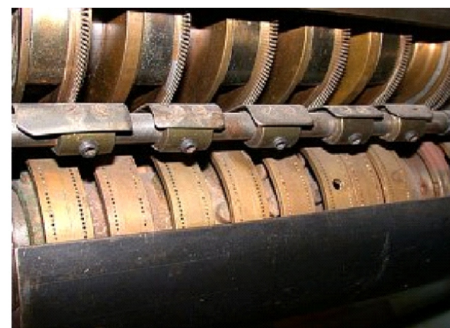
Lưỡi đục răng của máy rotary được G C Howard cải tiến
